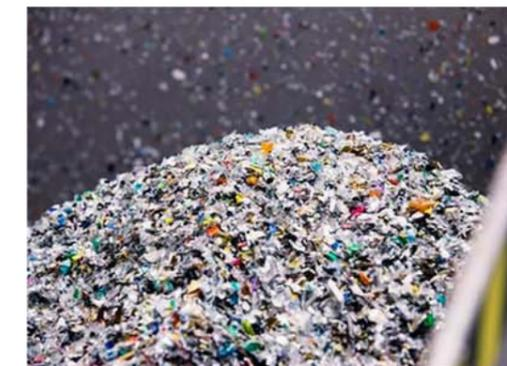
Durch verschiedene Trenn- und Reinigungsverfahren, entsteht dann schließlich ein Regranulat aus diesen recycelten und aufbereiteten Abfällen.
