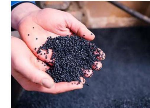
Dieses nachhaltige Kunststoffgranulat ist EUCert-Plast zertifiziert, da 80% oder mehr des Granulats aus recycelten Rohstoffen besteht.
